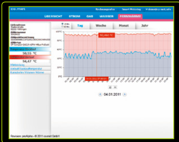
Fernwärmemessung (Vor- und Rücklauftemperatur)
