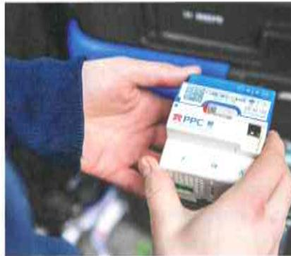
Das Smart Meter Gateway, hochsichere Kommunikationseinheit im intelligenten Messsystem, steht im Fokus des nun beginnenden flächendeckenden Einbaus smarterer Messtechnik. Bild: PPC
