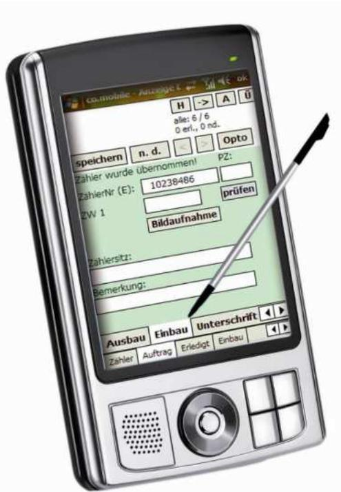
Im Zusammenhang mit der Installation von SMART-METERING-Komponenten ist die Automation der Datenerhebungsprozesse am Montageort unabdingbar. Auch ist in vielen Fällen eine Programmierung der Zähler und Zusatzgeräte vor Ort erforderlich (Zählpunktbezeichnung, Synchronisation von Uhren etc.).
